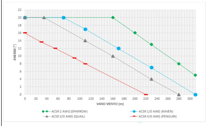
\* Elaborada con base en los criterios críticos en el diseño de estructuras para sistemas de distribución de energía
