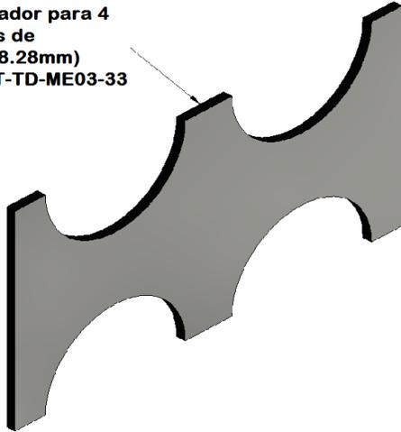
Separadores para 4 ductos de 4" (114.30mm)
