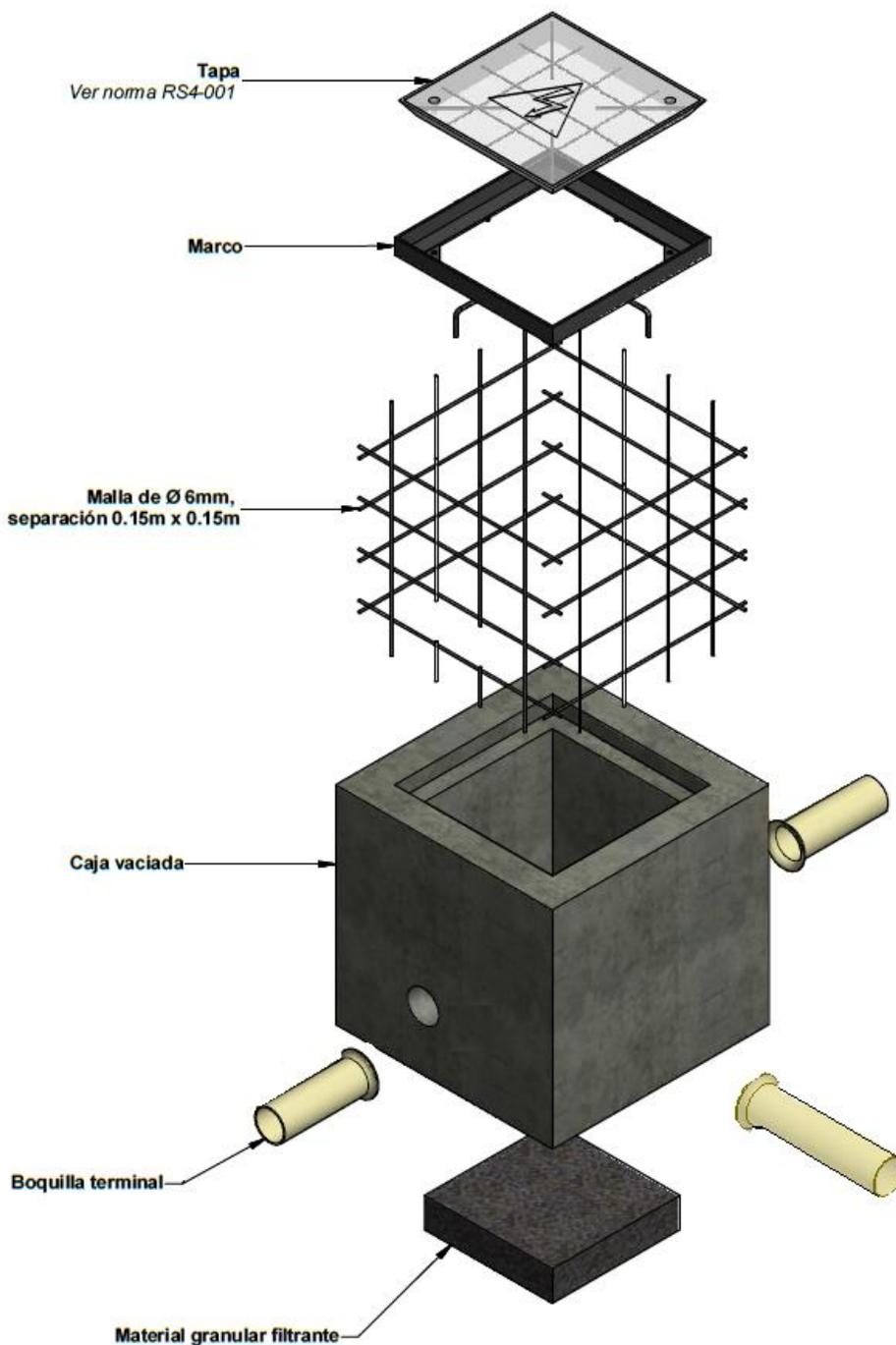
Nota: La cantidad de ductos que entran y salen de la caja depende de la condición de instalación.
