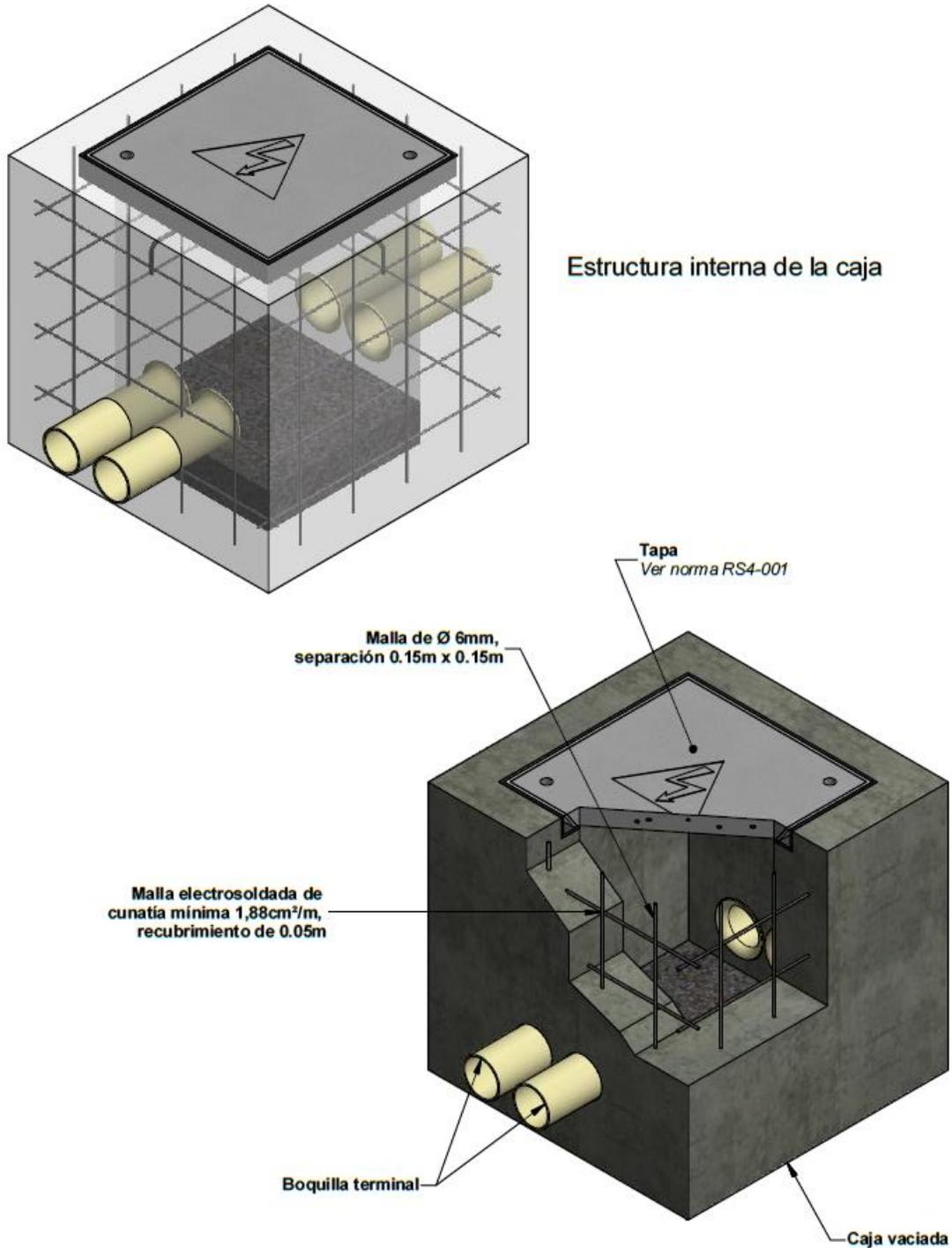
Nota: La cantidad de ductos que entran y salen de la caja dependen de la condición de instalación.
