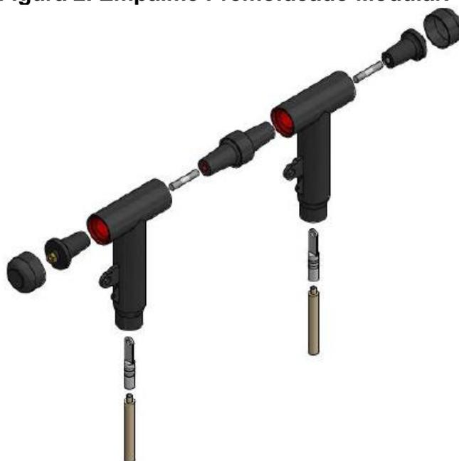
**Figura 3. Empalme Premoldeado Permanente.**
