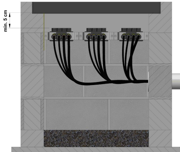
Figura 5. Instalación de barraje de derivaciones en caja subterránea
